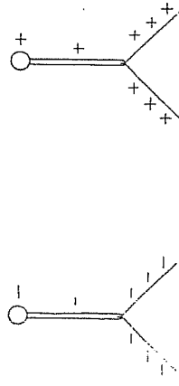
FIG. 10.8 Las hojas divergen cuando están cargadas ya sea positiva o negativamente
