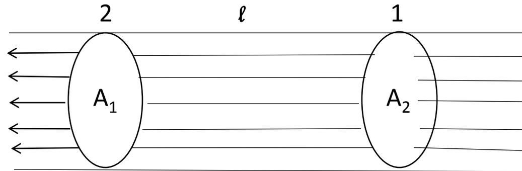
La energía de presión es igual al trabajo realizado para que las moléculas del líquido se desplacen del punto 1 al 2, una distancia originada por la fuga de presión entre una molécula y otra.
