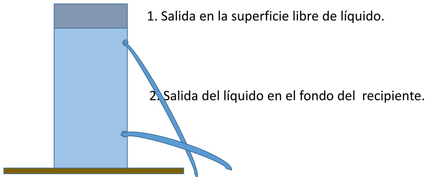
La velocidad con que sale un líquido por un orificio es mayor conforme aumenta la profundidad.(Teorema de Torricelli).
