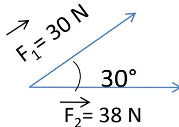
Solución por el método gráfico: se establece una escala y se trazan los vectores con un ángulo de  $30^\circ$ . Se dibuja la paralela de cada vector y se obtiene el paralelogramo. Se mide la resultante y el ángulo formado.
