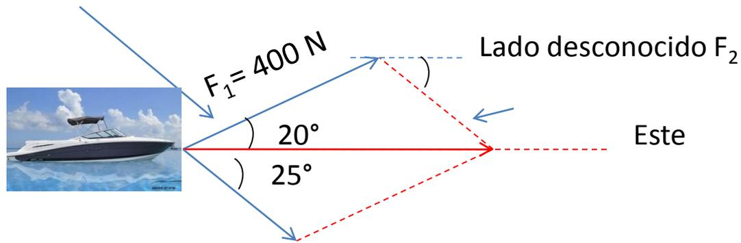
Se obtiene la magnitud de  $F_2 = 306.4\text{ N}$  y el ángulo  $\alpha = 26.5^\circ$
