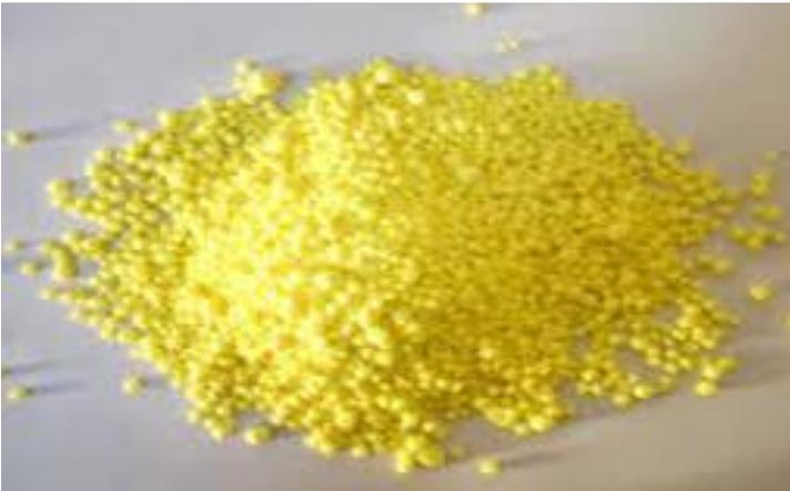
El azufre es un sólido amarillo. Se usa en la producción de ácido sulfúrico, fabricación de pólvora y vulcanización del caucho.
